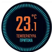
В центральной зоне отображается температура приточного воздуха в канале
