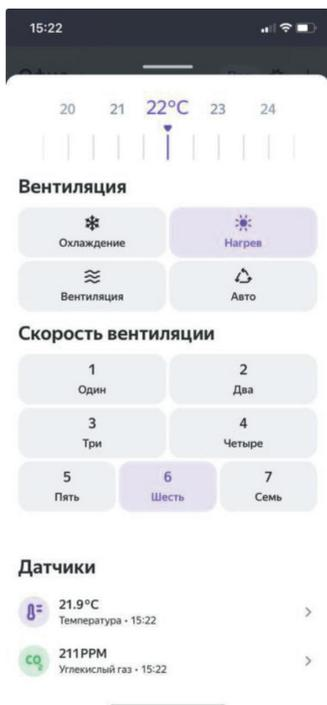
10. При выборе устройства «Вентиляция» открывается удобное меню с выбором уставки, режима работы, скорости, показанием датчиков.
