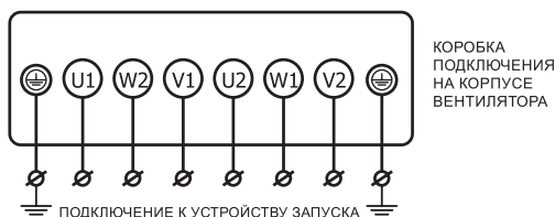
ПОДКЛЮЧЕНИЕ К УСТРОЙСТВУ ЗАПУСКА ПО СХЕМЕ "ЗВЕЗДА-ТРЕУГОЛЬНИК" Y-Δ
